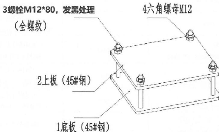
电芯夹具示意图 Steel plate
